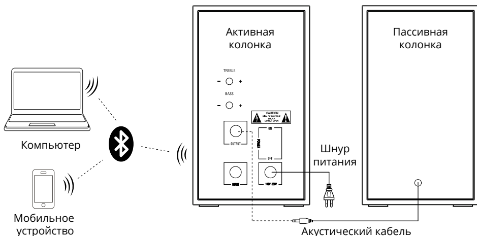
Рис. 3. Схема подключения источников аудиосигнала через Bluetooth-модуль
